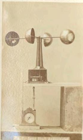
Fig. 7.—Lang Shaft Anemometer.
